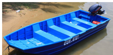
รูปทรงเรือท้องแบน : หัวตัด - ท้ายตัด หรือ หัวแหลม - ท้ายตัด
